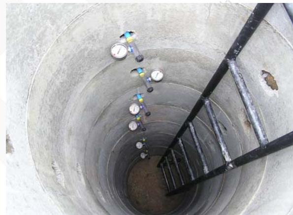
รูปที่ 7 การติดตั้ง Tensiometer (Mairaing et al. , 2006)
